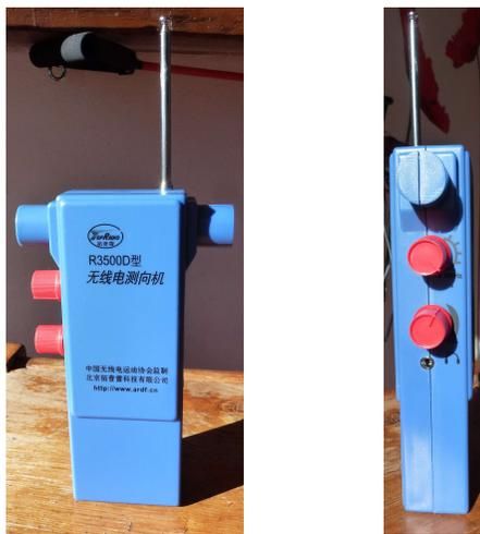
**OP-RADIO R3500D型无线电测向机套件 / 整机**
